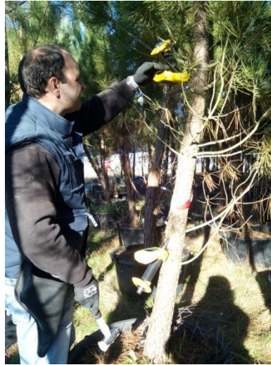
Figura 1: Medición de velocidad de desplazamiento de onda acústica sobre árbol en pie
