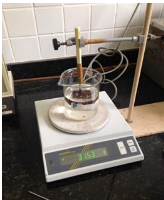
Figura 2: Medição de volume pelo método da balança hidrostática.
