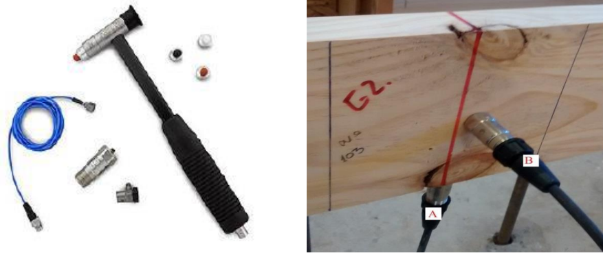
Figura 2: (a) Martillo de impacto modal. (b) Acelerómetros instalados.
