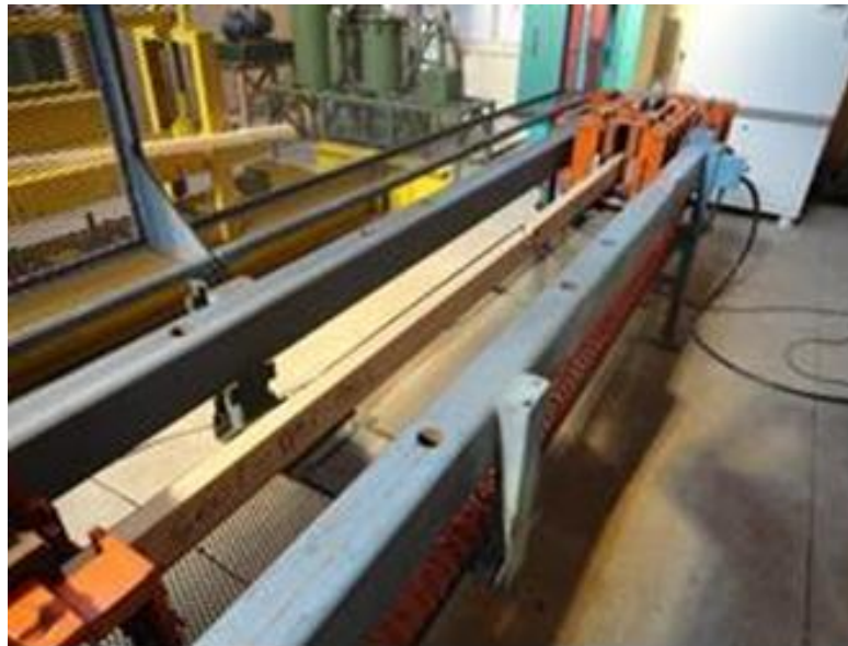
Figura 3: Configuración de ensayos. Sup: compresión paralela. Inf: Tracción paralela
