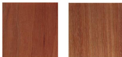
Figura 1: Aspecto externo da madeira de angelim vermelho: (E) corte tangencial; (D) corte radial. Fonte: [13].
