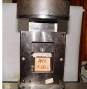
Figura 2: Ensaio de cisalhamento paralelo às fibras.
