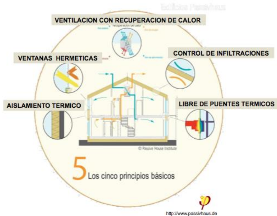
Figura 2: Esquema que muestra los principios básicos de una vivienda pasiva.
