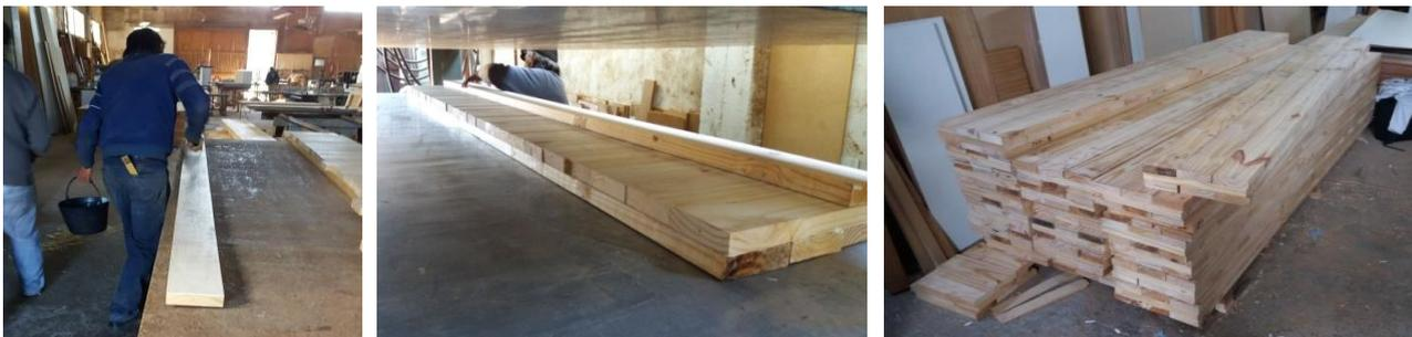
Figura 2: Proceso de fabricación de los paneles CLT
