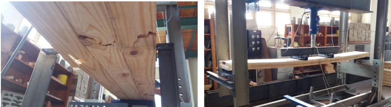
Figura 6: Ensayo a flexión en paneles CLT de pino uruguayo
