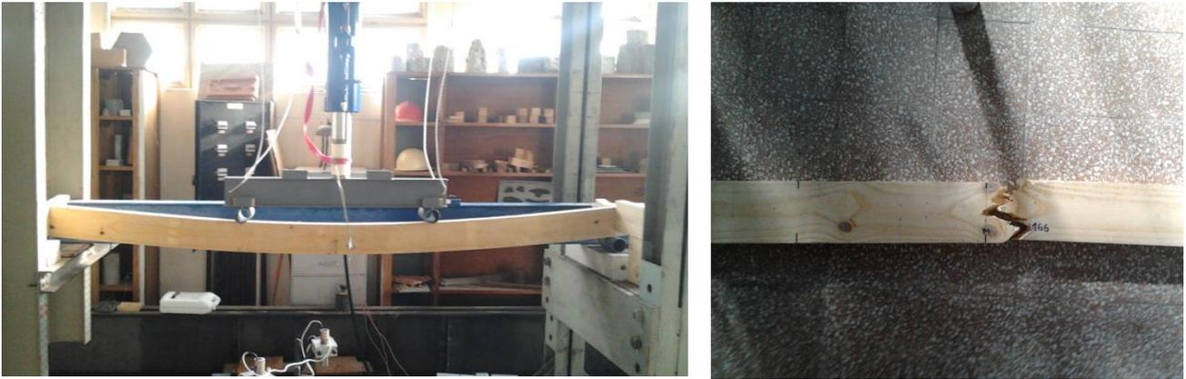
Figura 4: Ensayo a flexión en piezas de madera aserrada
