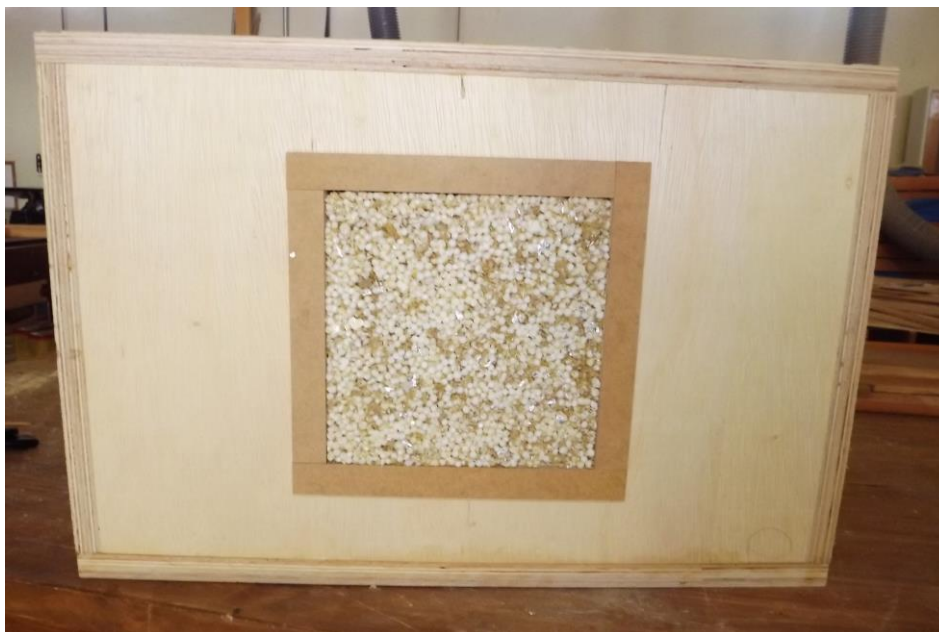
Figura 3: Minicâmara fechada com o corpo de prova encaixado.
