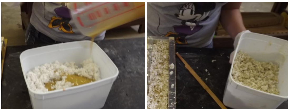
Figura 1: Processo de mistura da polpa celulósica com a resina.
