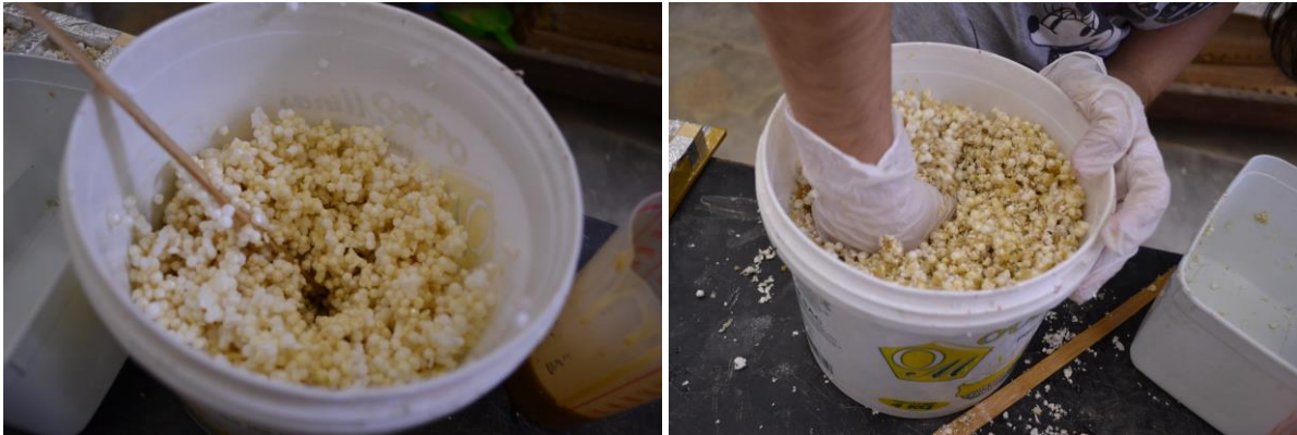
Figura 2: Mistura do isopor com a resina poliuretana e polpa celulósica.
