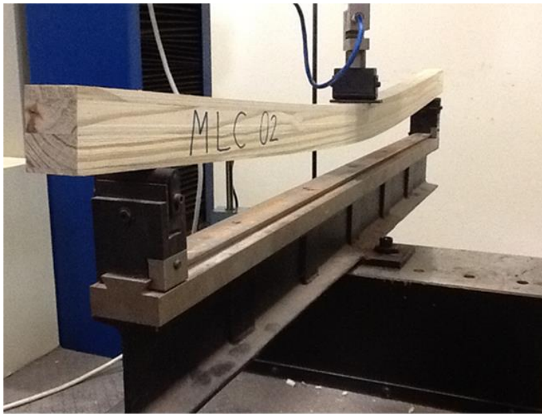
Figura 3: Ensaio de flexão estática
