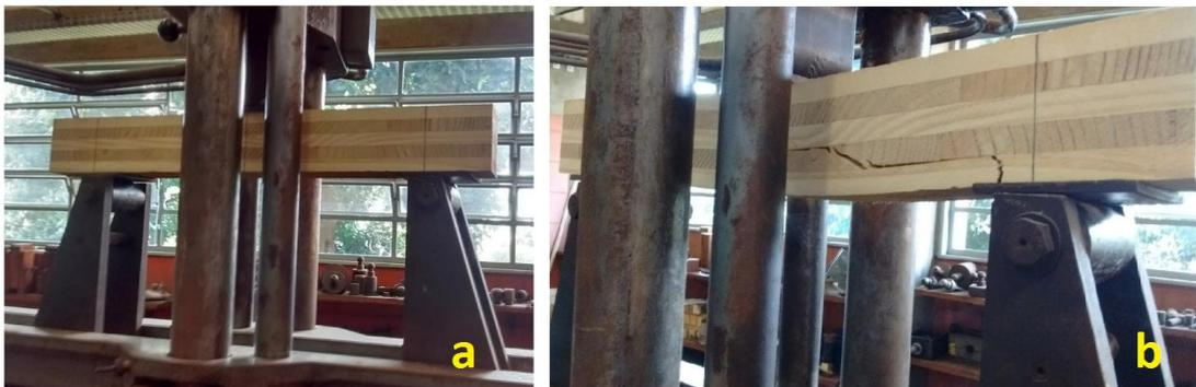
Figura 3: Ensaio de Flexão para avaliação do cisalhamento perpendicular; a) corpo-de prova antes do ensaio; b) corpo-de-prova após ensaio com as camadas transversais apresentando cisalhamento perpendicular
