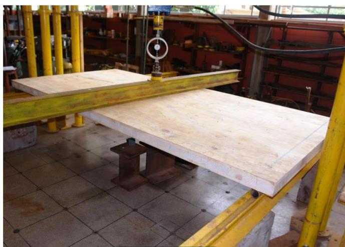
Figura 4: Ensaio de Flexão Longitudinal no Painel B
