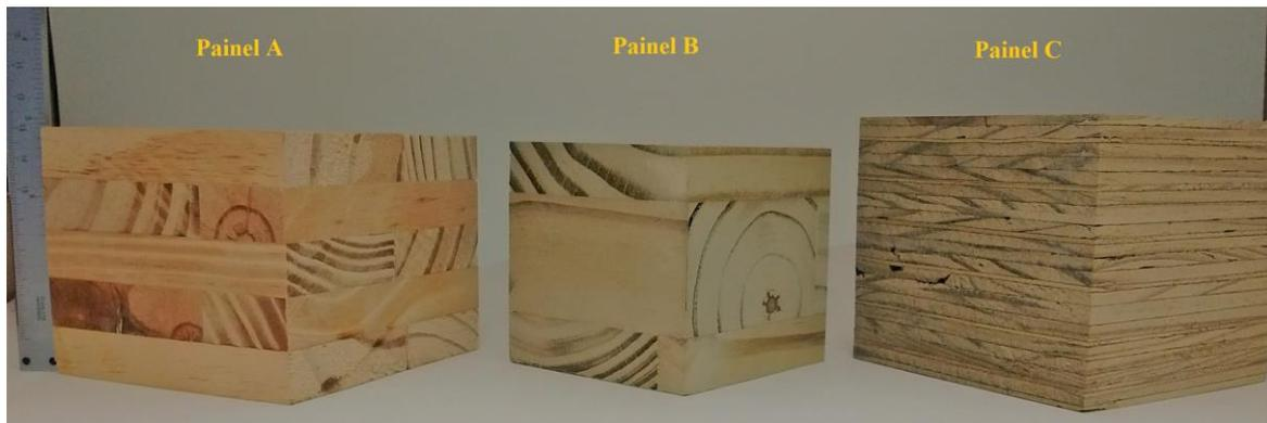
Figura 1: Modelos dos painéis de MLCC utilizados nos ensaios
