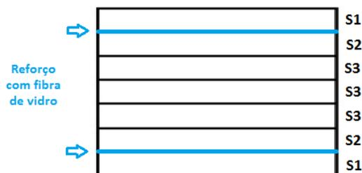
Figura 2: Posicionamento da fibra de vidro e das lamelas de acordo com a classificação visual.
