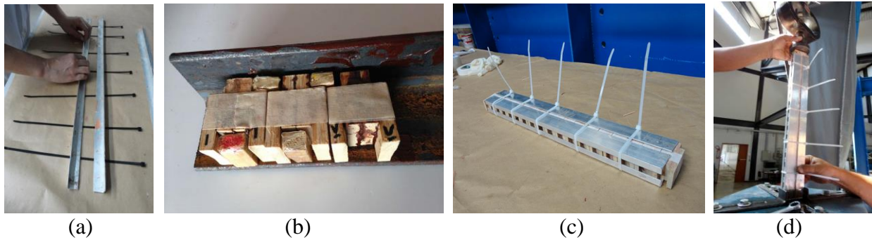
Figura 3: Sequência de montagem dos CPs: (a) Preparo das cantoneiras para receber os CPs; (b) Uso de madeira como gabarito na montagem; (c) CPs nas cantoneiras e (d) ; CPs posicionados no sistema de prensagem.
