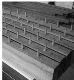
Figura 2: Barras de aço comum do tipo CA 50 (com mossas) coladas com resina epóxi em vigas serradas de madeira. Fonte: Molina (2008) [2].
