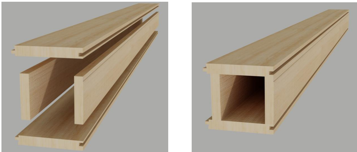
Figura 5: Modelo renderizado del prototipo de viga cajón
