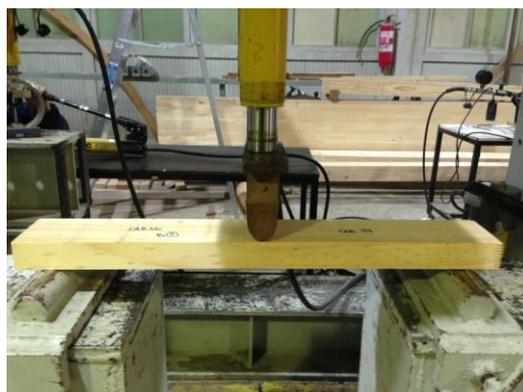
Figura 5: Ensayo de resistencia a la flexión.
