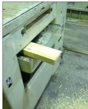
Figura 4: Proceso de cepillado de las probetas.
