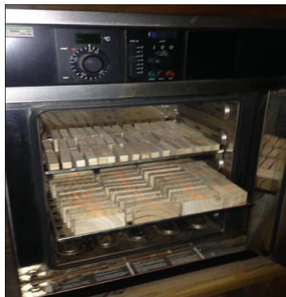
Figura 2: Proceso de secado en horno de las probetas
