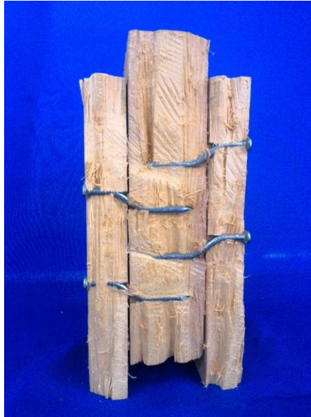
Figura 8: Modo de falha do resultado experimental
