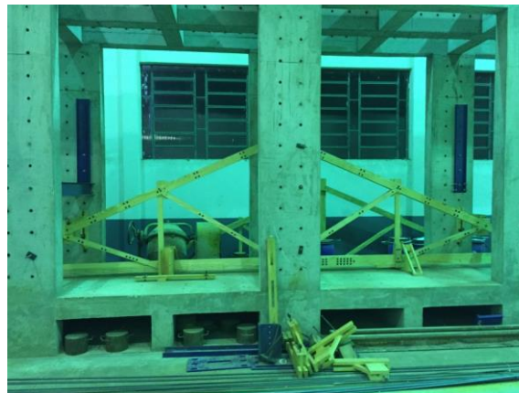
Figura 2: Treliça de madeira posicionada para ensaio no quadro de reações de concreto armado.
