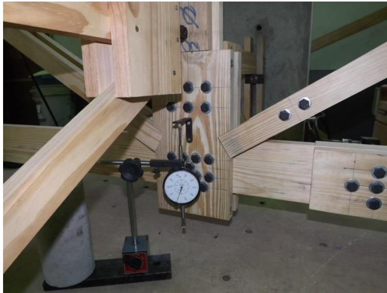
Figura 3: Relógio para leitura do deslocamento vertical instalado na estrutura.
