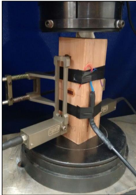
Figura 8: Corpo de prova instrumentado para ensaio.
