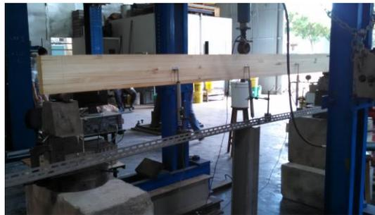
Figura 2: Viga de Madeira laminada colada posicionada para ensaio no laboratório de estruturas da Faculdade de Engenharia Civil, Arquitetura e Urbanismo da UNICAMP.
