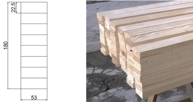
Figura 1: Detalhamento seção transversal das vigas de MLC apresentando suas dimensões em mm.
