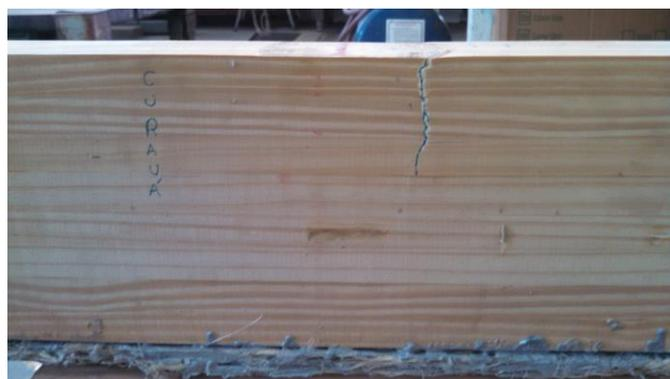
Figura 13: Detalha da ruptura por compressão da viga reforçada com Curauá.
