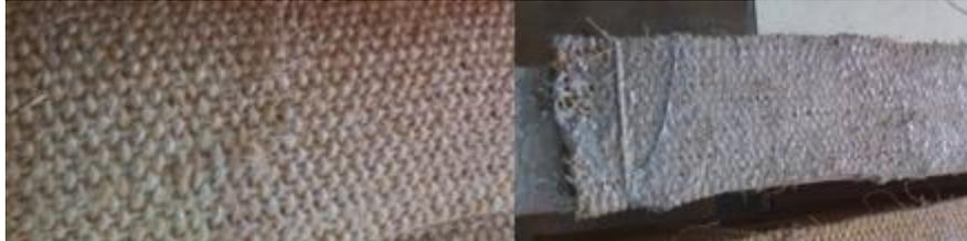
Figura 4: Detalhe das fibras de Sisal utilizadas no ensaio. (a) manta de Sisal trançado. (b) manta de Sisal aplicado à viga com resina epóxi.
