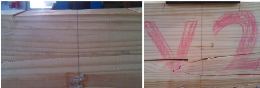
Figura 12: Detalhe da ruptura ocorrida na viga reforçada com fibras de Sisal.
