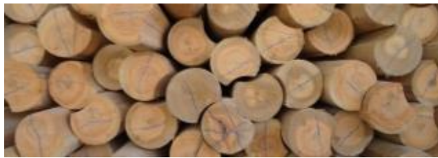
Figura 4: Madeira perfilada roliça, mostrando o diâmetro cheio e o com concavidade [10].
