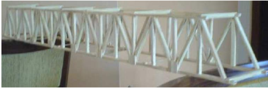
Figura 3.4: Modelo de ponte treliçada do tipo Warren Modificada construído com palitos de picolé. Fonte: (DUPLAT et al, 2008)
