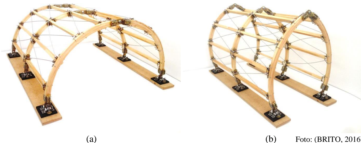
Figura 4.6: Modelo reduzido “Arcos MLC” simulações qualitativas do comportamento físico do sistema estrutural tridimensional com: (a) arcos abatidos; (b) e arcos mouriscos.
