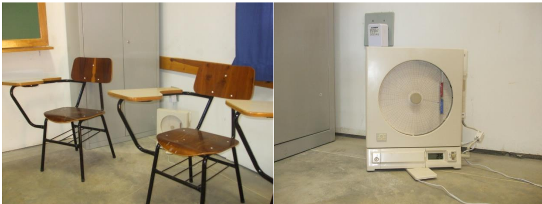
Figura 4: Localización del aparato de medición de la humedad ambiente.
