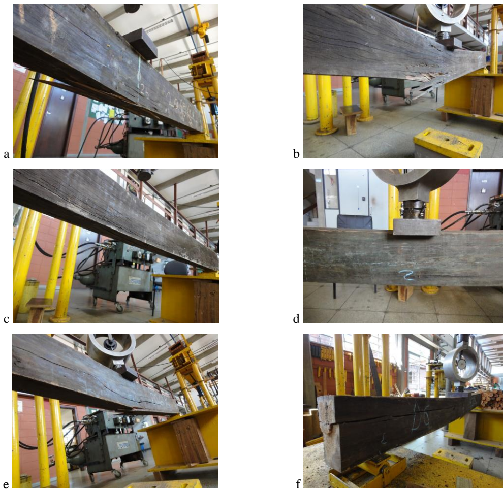
Figura 4.7: Modos de ruptura nas peças ensaiadas à flexão: a) D1; b) D2; c) D3; d) D4; e) D5; f) D6. Fotos: DUSSARRAT BRITO
