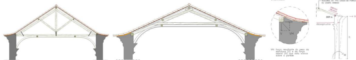
Figura 7: Desenho ilustrativo de um sistema estrutural com tesouras (esquerda) e cobertura em caibro armado (centro) com esquema de carga no apoio de um caibro armado (direita) (21)
