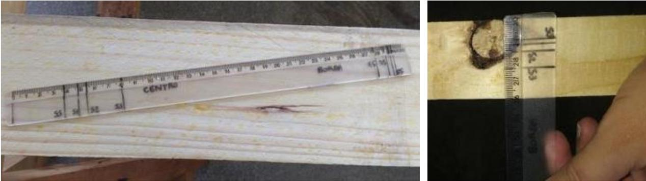
Figura 2: Modelo da régua com os limites de dimensões dos nós.
