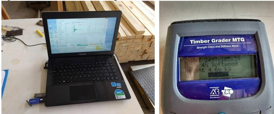
Figura 3: Computador com bluetooth e software de aquisição de dados e display do aparelho.
