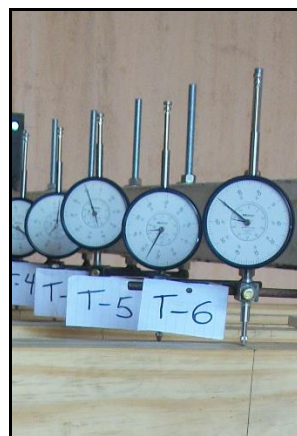
Figura 2: Medición de la deformación vertical
