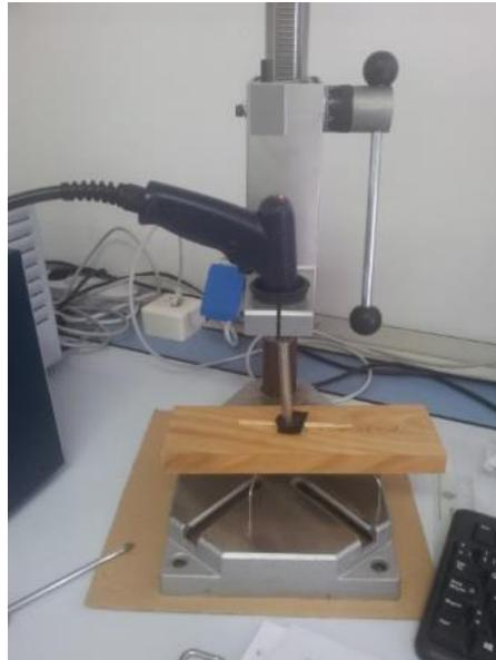
Figura 1: Escaneado de cores con la sonda del NIRs
