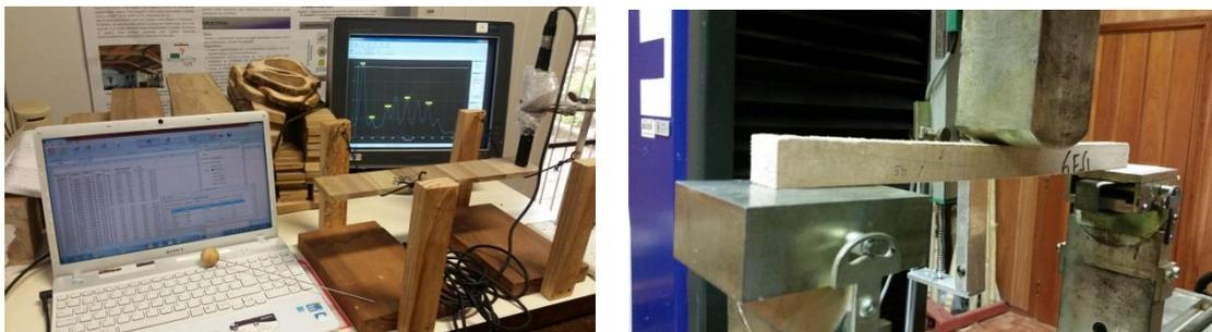
Figura 1: Montaje de referencia para NDT (izquierda) usando el programa BING y para la prueba de flexión longitudinal (derecha) con probetas de 410x25x25 mm de la especie *C. panamensis*
