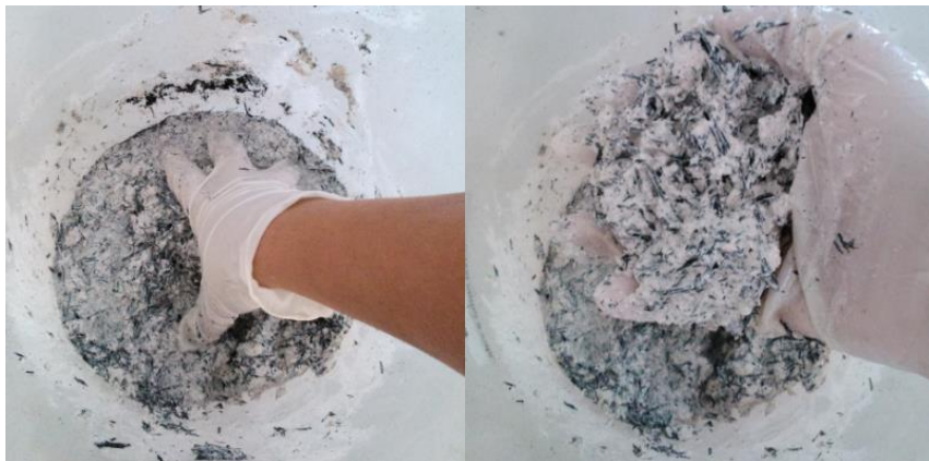
Figura 3: Mistura dos componentes para produção dos corpos de prova para ensaio térmico
