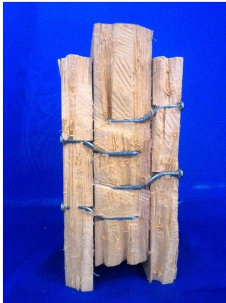
Figura 8: Modo de falha do resultado experimental
