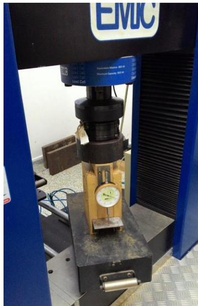
Figura 6 – Ensaio de resistência da ligação
