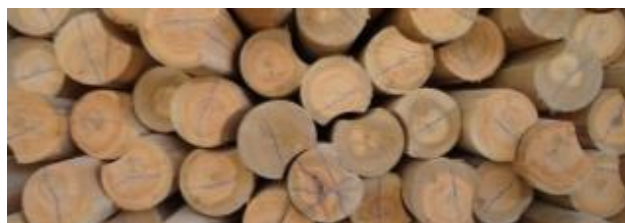
Figura 4: Madeira perfilada roliça, mostrando o diâmetro cheio e o com concavidade [10].
