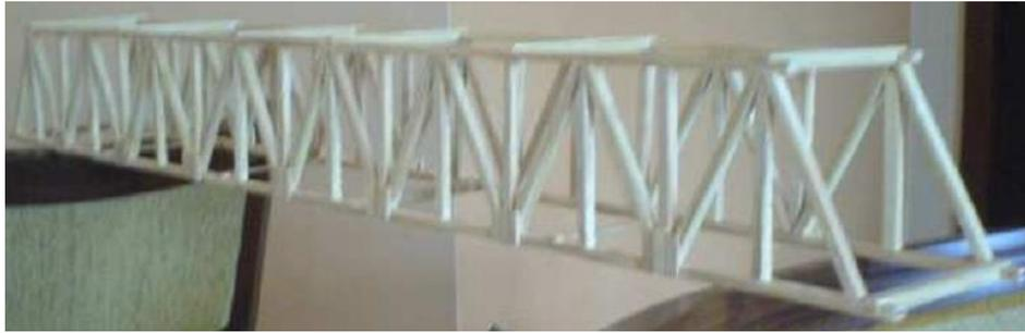
Figura 3.4: Modelo de ponte treliçada do tipo Warren Modificada construído com palitos de picolé.
