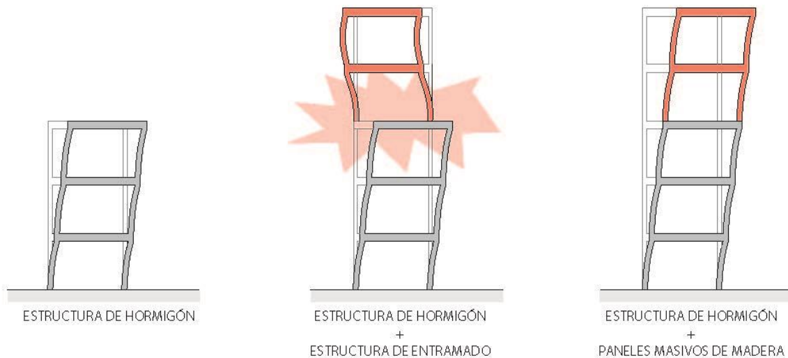
Figura 3: Comportamiento sísmico de ampliaciones utilizando sistema de marco tradicional y sistema de paneles de madera.
