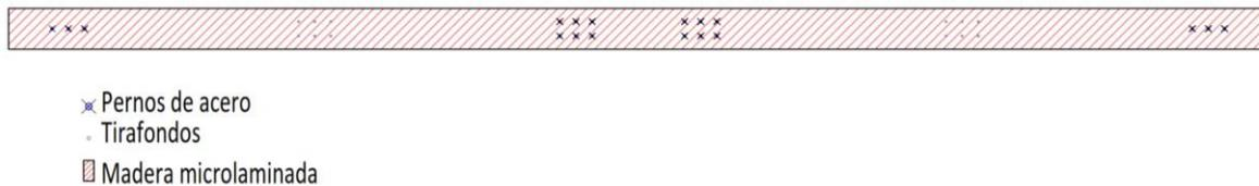
Figura 8: Representación gráfica del refuerzo de la unión entre piezas del tirante mediante madera microlaminada
