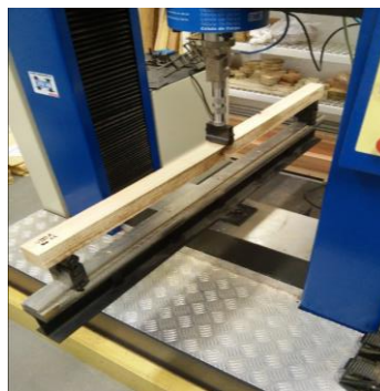
Figura 2: Ensaio mecânico de um corpo de prova de flexão estática.
