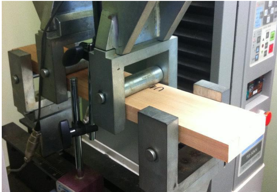
Figura 2: Ensayo a flexión de las uniones dentadas con máquina de ensayos universal Minebea
