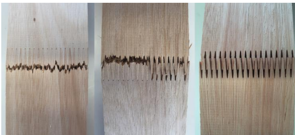
Figura 3: Modos de fallo de las uniones dentadas: Modo 1 Madera (izquierda), Modo 2 Mixto (centro) y Modo 3 Adhesivo (derecha)
