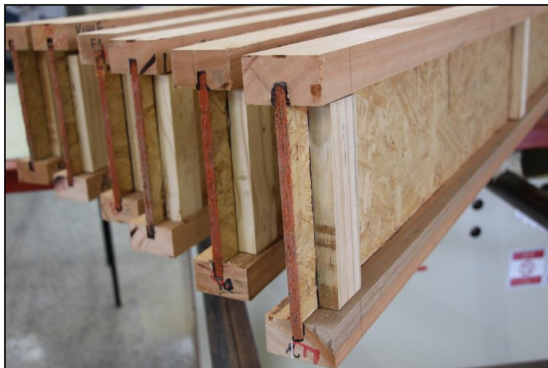
Figura 8: Vigas “I-Joists” confeccionadas.
