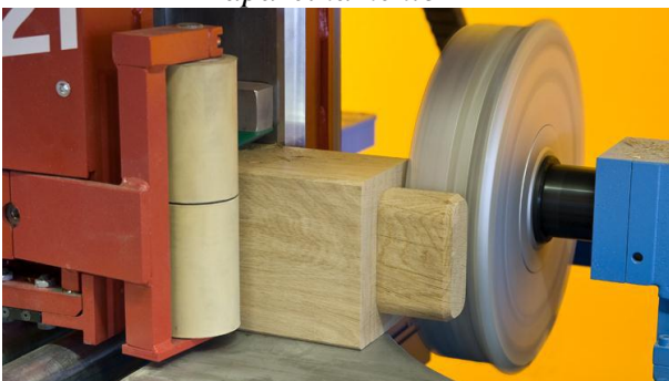
(e) Fabricação das peças de MLC - usinagem com máquina CNC
