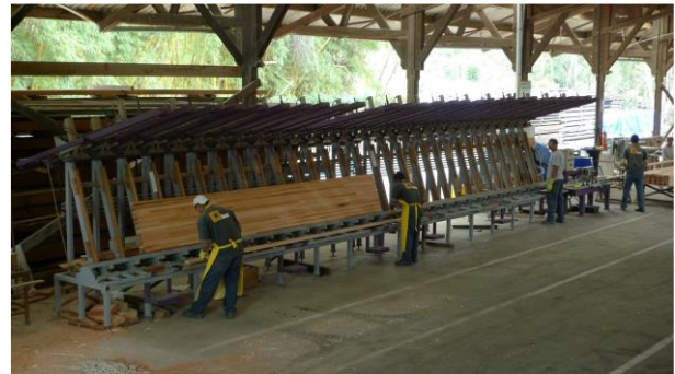
(d) Laminação das tábuas, colagem das faces e prensagem das tábuas
