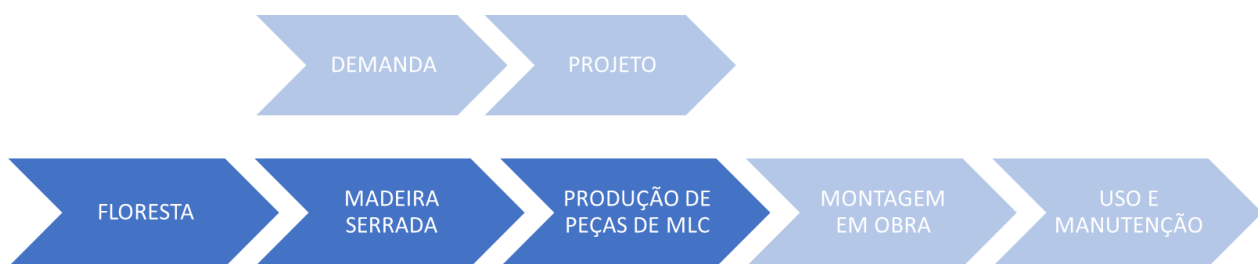
Figura 1: Síntese da cadeia produtiva de peças em madeira laminada colada mlc
